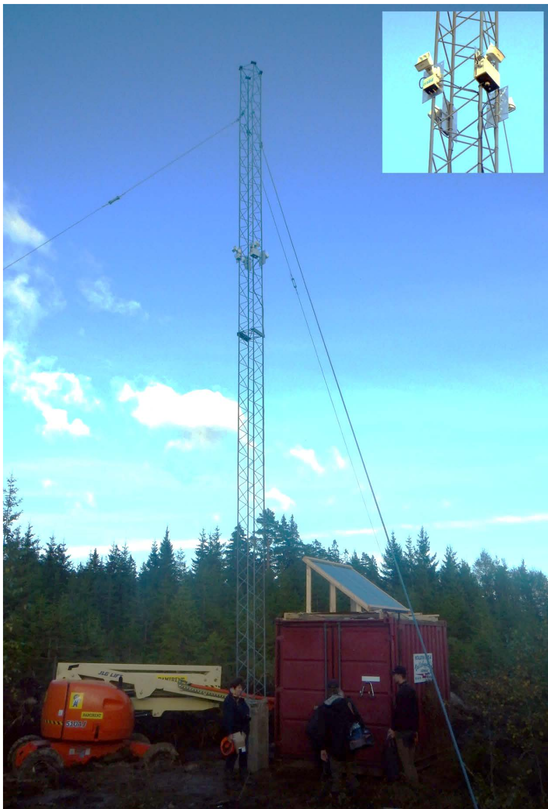
Figur 14. Installation av DTBirds detektionsmodul i en vindmätningmast på Billingen mellan Skara och Skövde i syfte att övervaka flyttningen av tranor över ett tilltänkt vindprojekteringsområde. En container användes för att montera detektionsmodulen. Internetuppkoppling för kontakt med webbplattform åstadkoms med ett mobilt bredband. Elförsörjning löstes genom användande av solpanel. Täckningen på det mobila bredbandet fungerade inte hela tiden, men då det monterade DTBird-systemet lagrade all data lokalt, överfördes data kontinuerligt när systemet kom online. Som helhet fungerade undersökningen mycket bra. Infällt uppe till höger syns inzoomad bild på monterade kameror.
